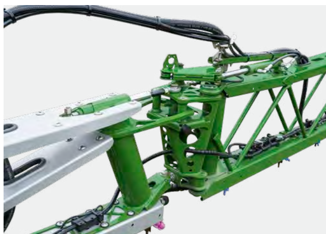
Rampe Super-L3 de 36 m, pouvant être réduite à 24 m et 12 m
