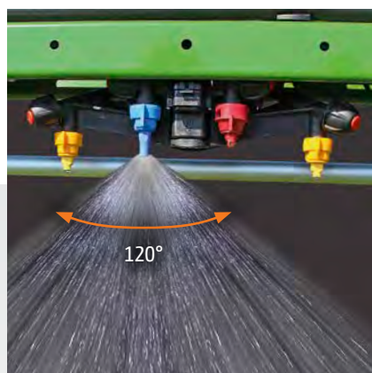
Coupure électrique individuelle des buses AmaSelect avec buse quadrijet et un écart de buses de 50 cm ou 25 cm
