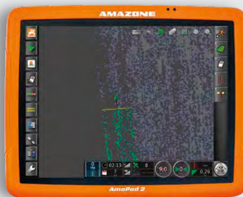
Traitement de la carte de modulation localisée sur l'AmaPad 2
