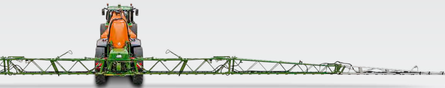
UX 11201 Super avec rampe Super-L3 de 36 m
