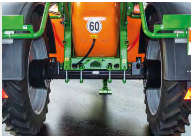
Essieu fixe avec largeurs de voie de 1,50 m à 2,25 m
