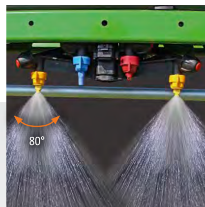
Coupure électrique individuelle des buses AmaSelect avec buse quadrijet et un écart de buses de 50 cm ou 25 cm
