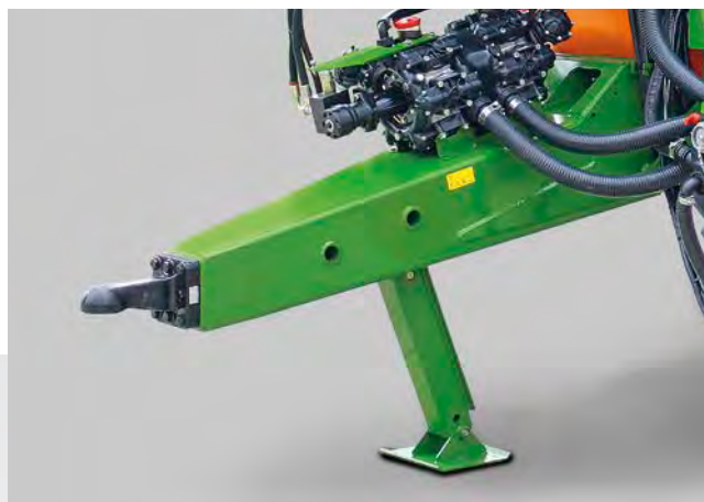
Attelage en position basse avec anneau et béquille mécanique
