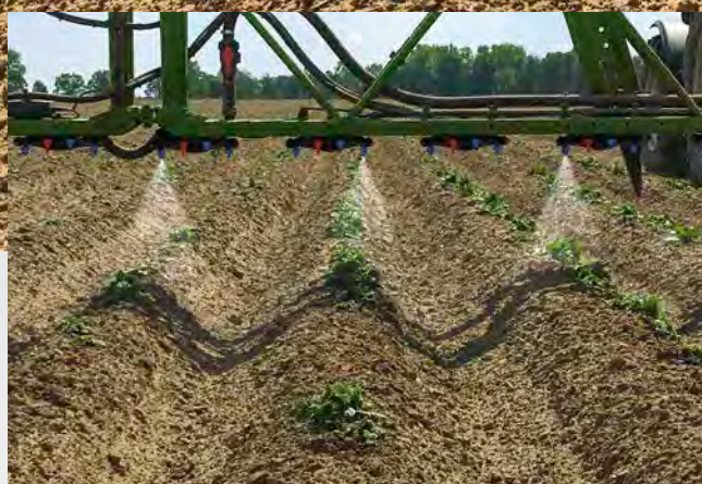
Pulvérisation en bandes en fonction des rangs dans la culture de pommes de terre
