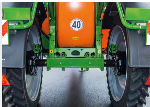
Essieu réglable avec réglage de la largeur de voie en continu de 1,50 m à 2,25 m
