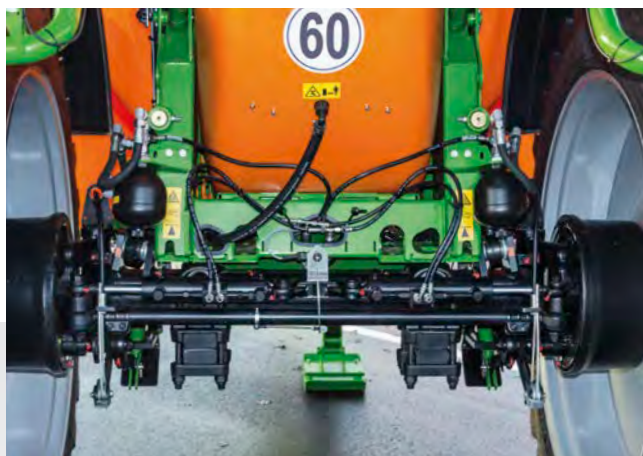
Suspension hydropneumatique d'essieu avec fusées directrices AutoTrail
