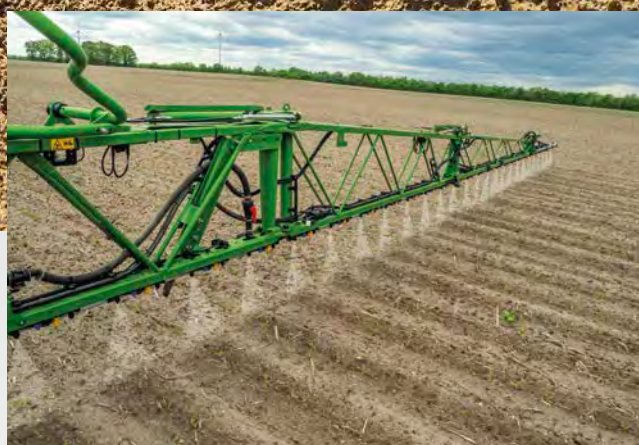
Pulvérisation en bandes en fonction des rangs dans la culture de betteraves à sucre
