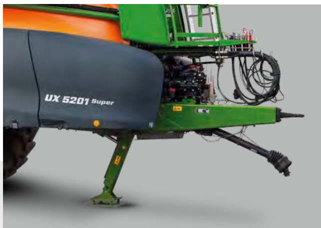
Attelage en position haute avec anneau et béquille hydraulique
